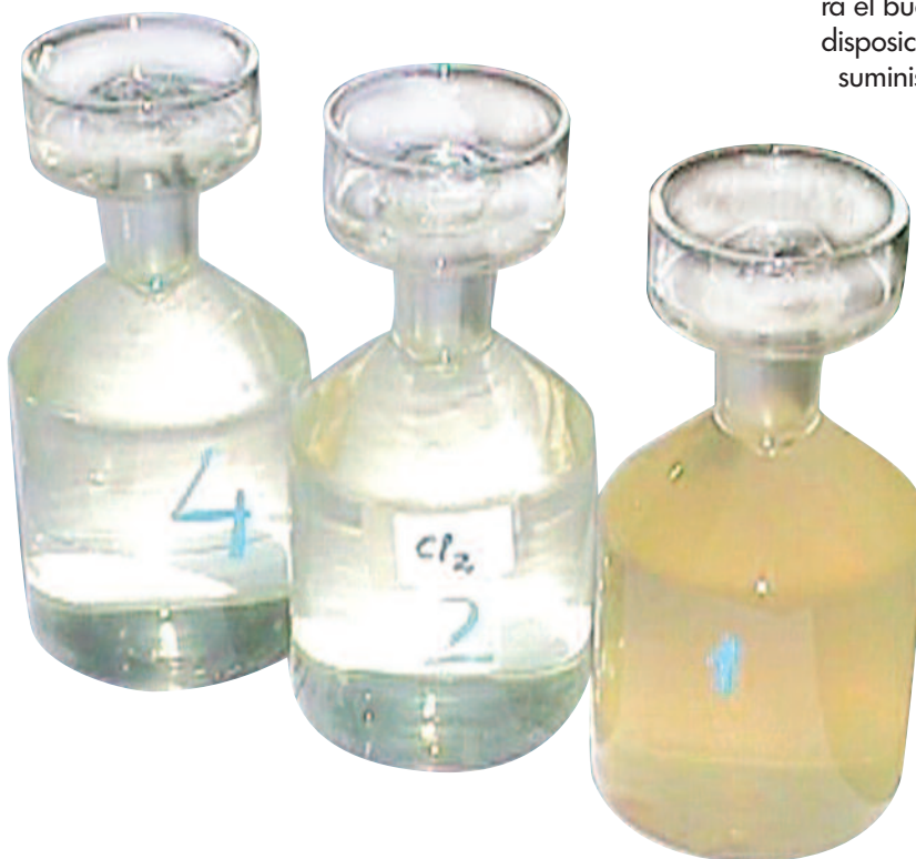
Aspecto de los diferentes pasos del tratamiento de regeneración. 1- Agua de secundario. 2- Agua filtrada y clorada. 4- Agua desalada para distribución.
