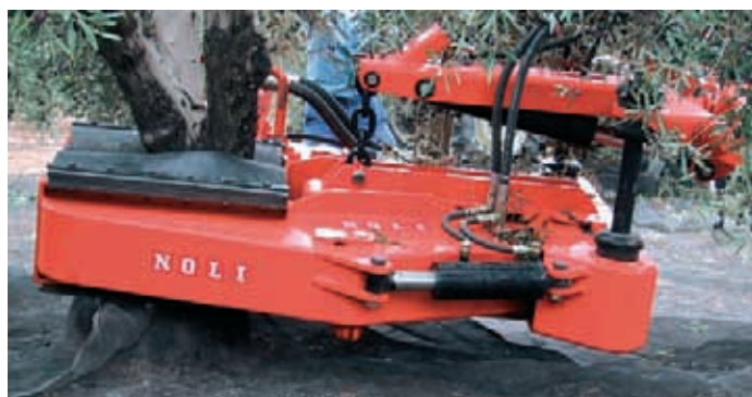
Cabezal de un vibrador multidireccional de troncos para el derribo de las aceitunas. Detalle del agarre a un olivo mal formado para este sistema de recolección.
