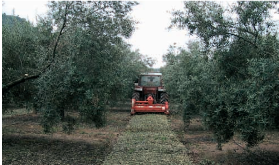
Mecanización de la destrucción de los restos de poda, con su incorporación al suelo, previo alineamiento, en una calle del olivar, de los ramones (fracciones leñosas y foliáceas).
