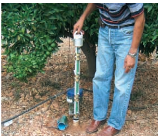
Sensor para la medición de la humedad del suelo. Foto: Consejería de Agricultura, Pesca y Alimentación. Comunidad Valenciana
