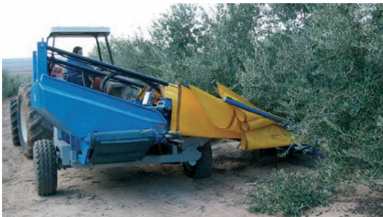
Paraguas invertido plegado para su acoplamiento al olivo en una máquina vibradora de troncos.
